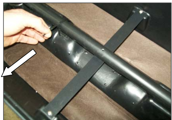
Fixez le tuyau d'alimentation avec une Tire rap au bac de culture à l'endroit prévu à cette fin. Fixe the alimentation tub with a Tire rap to the culture bac.
