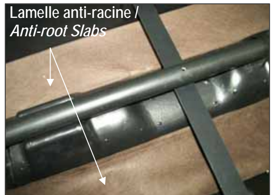
Mettre les deux (2) lamelles anti-racines au fond de chaque bac de culture. Place two anti-root slabs at the bottom of each culture tub (Figure 5.2).
